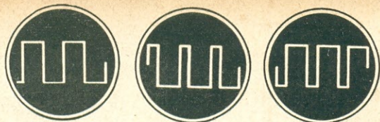
FIG. 7 — O potenciômetro R1 serve para tornar perfeitamente linear a forma de onda. Quem possuir um osciloscópio, poderá girar o cursor de R1 de modo a obter em sua tela a forma de onda da direita. Os oscilogramas da esquerda e do meio mostram a onda quadrada quando o R1 não está regulado devidamente. Se o leitor não tiver osciloscópio, poderá proceder como explicado no texto.
