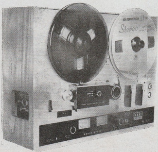
Foto 1 — Foto em perspectiva vindo-se na lateral o painel embutido onde estão localizadas as entradas.
