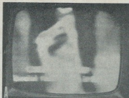
FIG. 1 — Sintomas observados na imagem de um receptor de TV, indicando a necessidade de um alinhamento.
