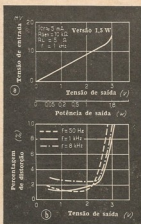
FIG. 20 — A) Tensão de entrada do amplificador da FIG. 18 para determinada potência de saída. B) Variações da percentagem de distorção em função da tensão de saída no caso de estar sendo usada a fonte de 9 volts.
