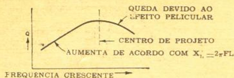
FIG. 3 — Variação do "Q" com a frequência.
