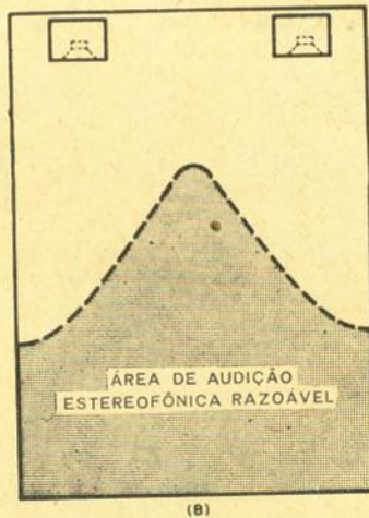
FIG. 2 — O sistema combinado (A) pode limitar por demais a cobertura de uma sala grande. Neste caso, alto-falantes separados trabalharão melhor.
