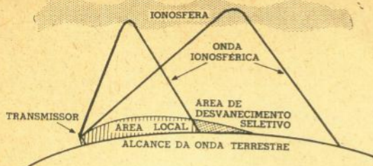
FIG. 3 — Percursos das ondas terrestre e ionosférica.
