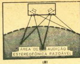
FIG. 1 — Alto-falantes afastados em uma sala pequena (A) podem restringir demais a área aceitável de estereofonia. O sistema combinado em um único sonofletor (B) pode, neste caso, desempenhar melhor a tarefa.
