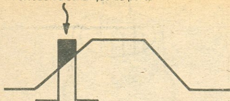
Fig. 7 - Ilustração que mostra o tempo de coincidência de sinais na porta comparadora.
