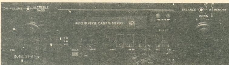
Foto 3 — Um moderno receptor/toca-fitas para automóvel com seis memórias para estações de AM e FM, Dolby, relógio digital, controle de graves e agudos, equilíbrio lateral e frente/trás, seletor de fitas entre outros recursos.
