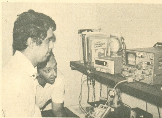
Foto 2 — Aguiar (em primeiro plano) e o autor, durante a medição de ganho da cápsula do AFM-SD, que aparece na tela do osciloscópio.
