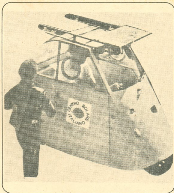
Foto III — Veículo elétrico de três rodas, alimentado por painéis fotovoltaicos testado pelo Centro Solare Italiano.
