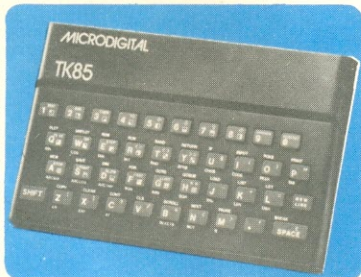
Aspecto do painel superior do TK85, com seu teclado tipo "máquina de escrever".
