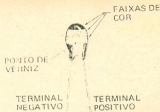
FIG. 16 — O capacitor de tântalo é também um componente polarizado, como o
