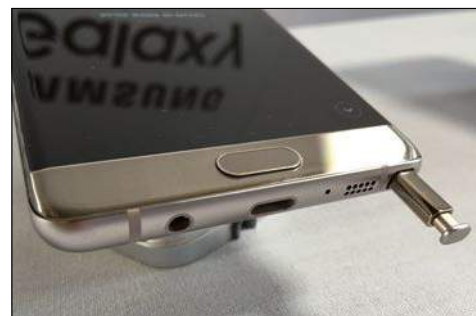
El conector USB de tipo C reversible nos permite, entre otras cosas, transferir archivos a mayor velocidad.
