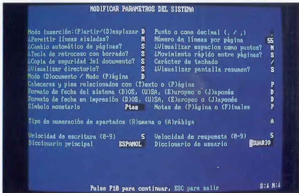
Pantalla para la modificación de los parámetros generales del sistema. Conviene decir sí a la generación automática de copias de seguridad.
