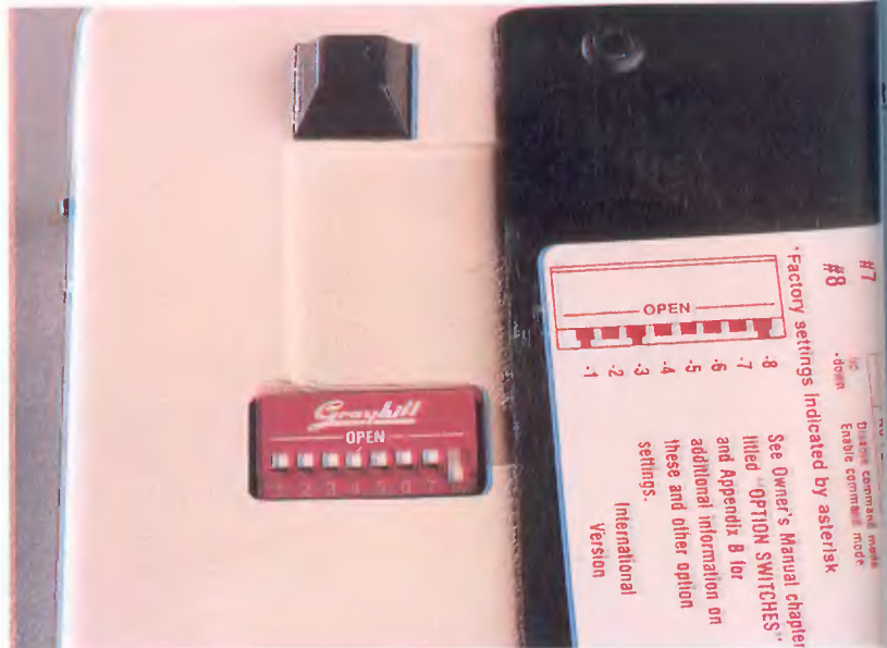
Los switches de configuración se encuentran en la parte inferior del modem.
