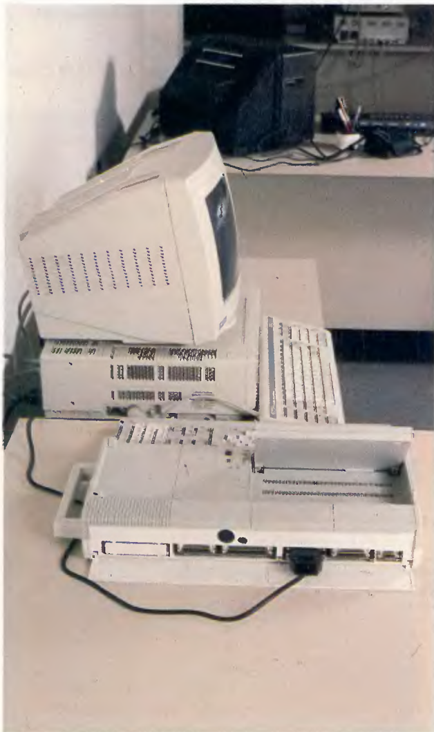
PPC 512 conectado a un PC 1640 y dispuesto a comenzar el intercambio de ficheros.
