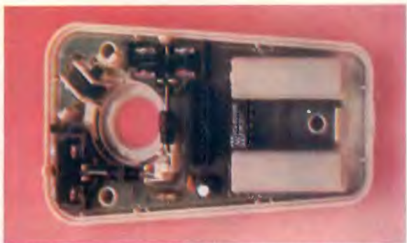
Vista del ratón del PC 1512 tras retirar la parte superior de la carcasa.
