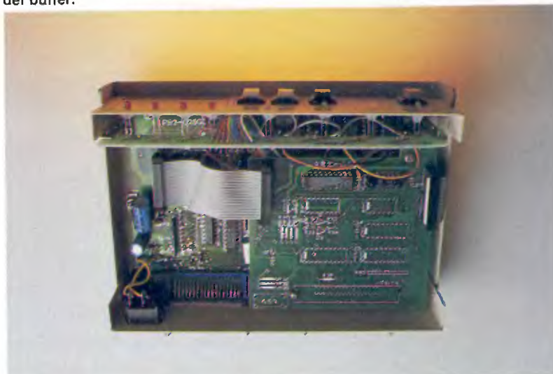
Interior del buffer de impresora de Microhard.
