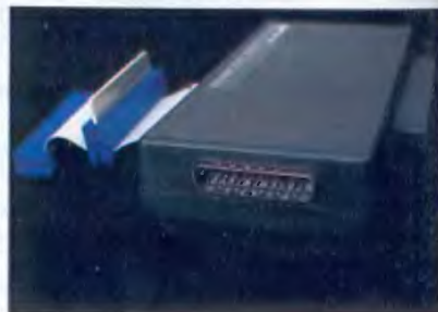
El conector del cable RS232 es del tipo «macho».
