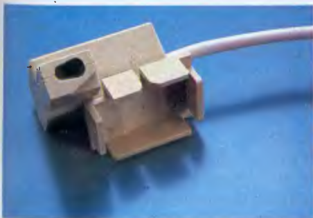
Este es el conjunto Iluminación-sensor óptico.
