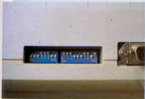
Vista de los switches de la impresora Amstrad DMP 3000. El switch DS2-4 aparece en posición ON.
