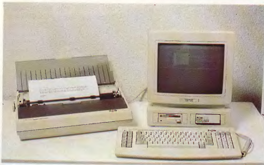
El nuevo AMSTRAD PCW 9512: Impresora de margarita, teclado y Unidad Central-Monitor monocromo.
