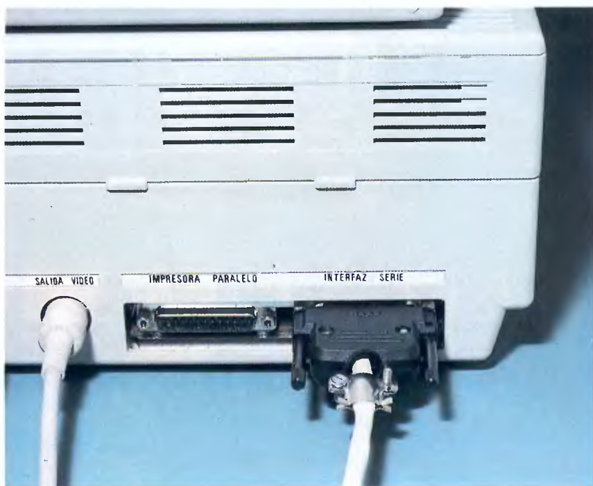
Vista posterior del PC con el cable RS232 conectado. El interface va por dentro.
