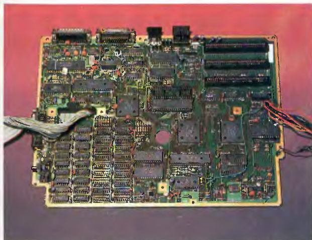
Placa principal del PC 1512 tras quitar el blindaje. En la esquina inferior izquierda se observan los zócalos para la memoria extra.
