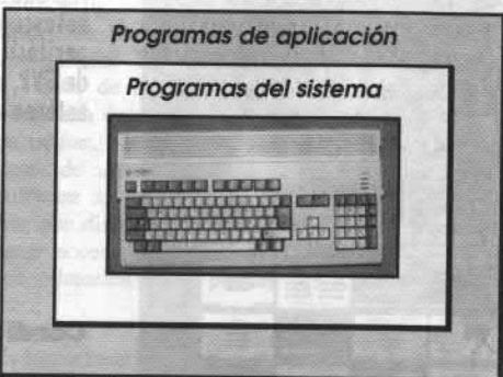
Figura 1. Relación entre programas de aplicación y programas del sistema. Los programas del sistema suelen tener una estrecha relación con el hardware de la máquina.
