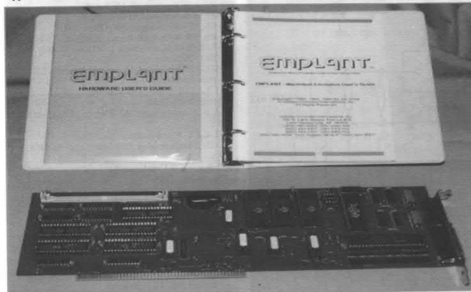
Figura 1. Vista frontal de la tarjeta junto a su manual. Podemos observar el alto nivel de integración de los circuitos. La tarjeta está prácticamente vacía y el 90% de la superficie lo ocupan unos zócalos para futuras ampliaciones: memoria, ROM, Módulo 586i, etc...
