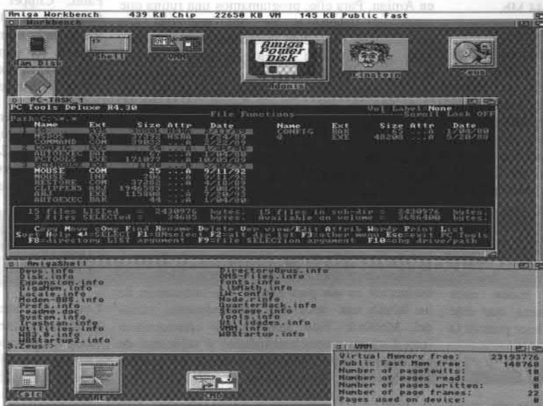
Fig.2 El PCTask puede abrirse como una ventana del Workbench y trabajar en multitarea con otras aplicaciones.
