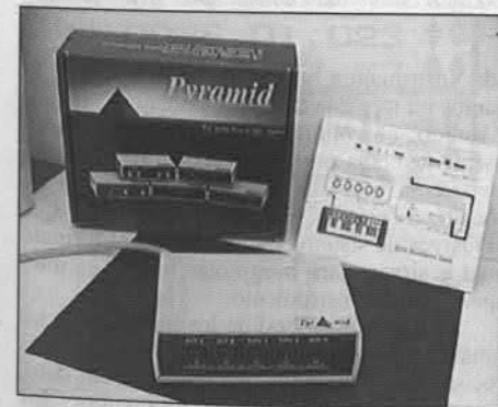
1. Muestra del interfaz midi externo, utilizado por Santi. Este modelo puede conectarse a cualquier Amiga.
