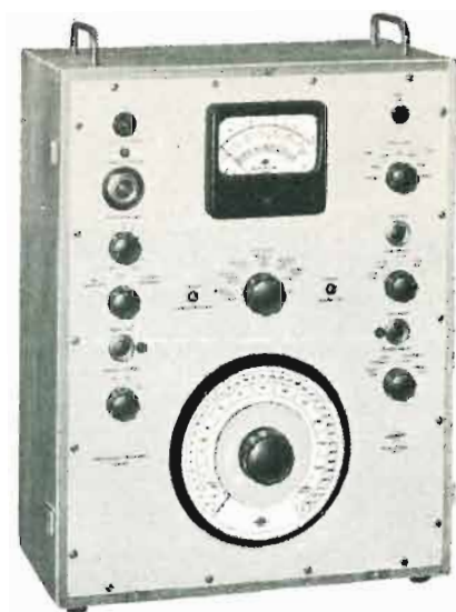
g) Spettrometro Tipo 2111 per l'analisi di disturbi e vibrazioni a banda 1/3 di ottava e a banda di un'ottava.
