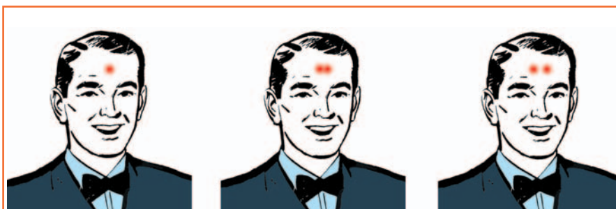
Figure 21: Pour mesurer la température corporelle d'une personne, vous devez presser et maintenir P1 et approcher le thermomètre du front jusqu'à obtenir un cercle rouge. Relâchez alors P1 et attendez que la LED clignote quatre fois: vous pouvez lire la température instantanée de la peau sur l'afficheur LCD. Si une ellipse apparaît, vous devez vous rapprocher, si un huit apparaît, vous éloigner.
