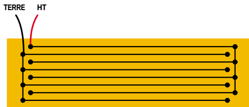
Figure 6 : Pour protéger l'appui d'une fenêtre contre les salissures des pigeons, il suffit de tendre, sur une planche de bois, une série de fils de cuivre distants les uns des autres de 3 à 4 centimètres.
