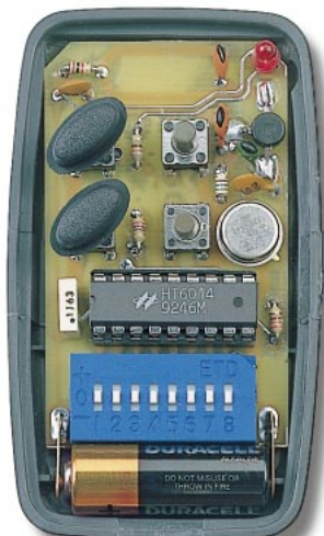
Figure 16 : Après avoir inséré le circuit à l'intérieur du boîtier, il faut installer les petits capuchons ovales sur les axes mobiles des quatre boutons poussoirs.
