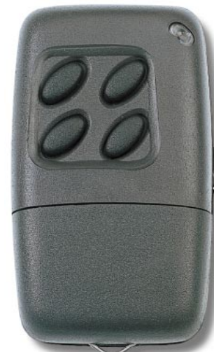
Figure 18 : Photo du petit émetteur de poche. Chaque fois que vous appuyez un poussoir, la petite LED située en haut à droite du boîtier s'allume.
