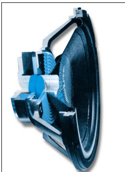
Figure 174 : Une bobine mobile est placée dans un aimant au centre et à l'arrière du cône d'un haut-parleur. En appliquant une tension alternative à cette bobine, on obtient une oscillation du cône de même fréquence.
