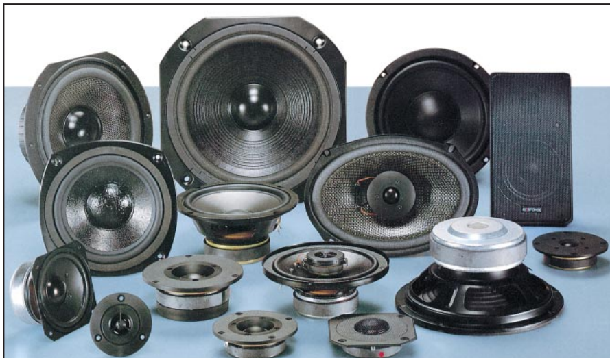
Figure 178 : A l'intérieur des enceintes acoustiques des amplificateurs hi-fi sont installés deux ou trois haut-parleurs de différents diamètres. Celui dont le diamètre est le plus important est appelé "woofer". Il est utilisé pour reproduire les notes basses. Celui dont le diamètre est intermédiaire est appelé "médium". Il est utilisé pour reproduire les notes moyennes, tandis que celui dont le diamètre est le plus petit est appelé "tweeter" et sert à reproduire les notes aiguës.
