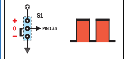
Figure 6 : Les broches du codeur qui sont reliées à la masse par l'intermédiaire du dip-switch S1, permettent de générer deux impulsions larges.
