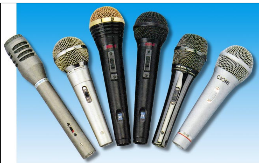
Figure 187 : Différents types de microphones employés par les orchestres et par les chanteurs. Les plus utilisés sont ceux de type électromagnétique et piézo-électrique.
