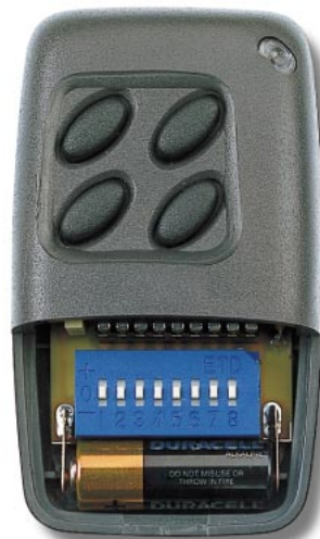
Figure 17 : Le couvercle du boîtier est divisé en deux parties afin d'accéder de façon commode à la pile pour la changer lorsqu'elle est déchargée.
