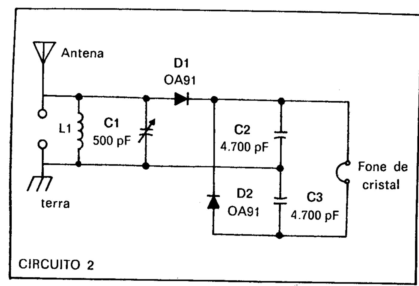
liza um cristal piezelétrico para movimentar seu diafragma, sendo excitado por tensão. O tipo de fone normalmente utilizado em rádios transistorizados não é recomendável.
