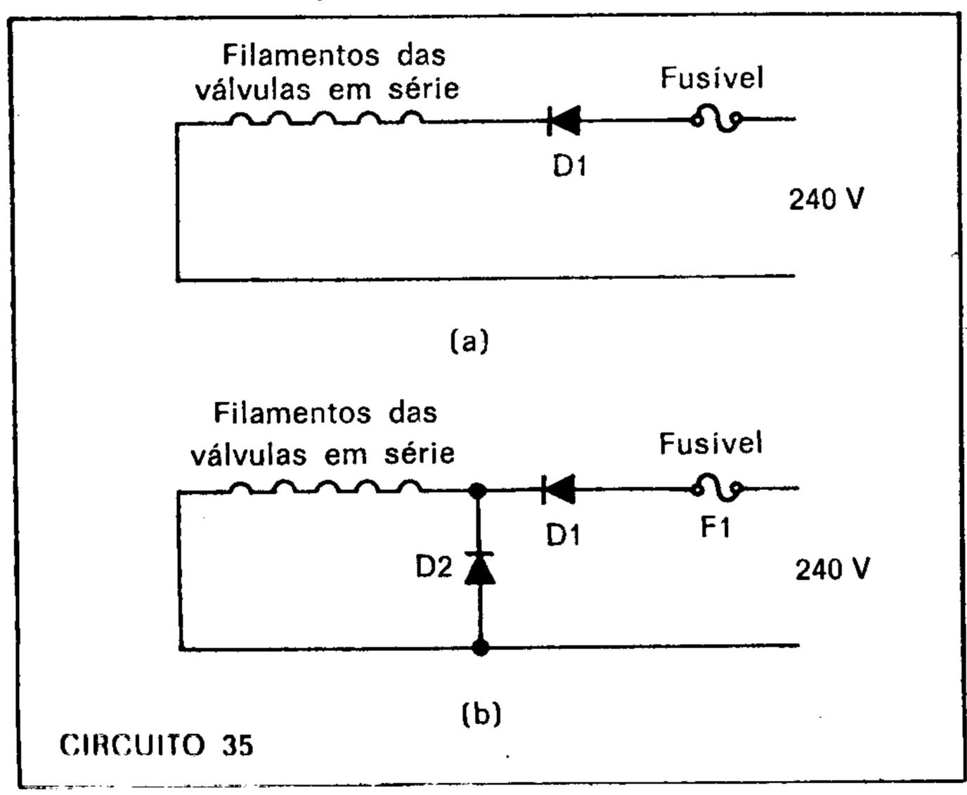
normalmente, D2 ficará inversamente polarizado, e a corrente não passará através dele. Contudo, se D1 entrar em curto, D2 passará a conduzir, colocando em curto os filamentos. Com isso uma apreciável corrente irá circular, queimando o fusível.
