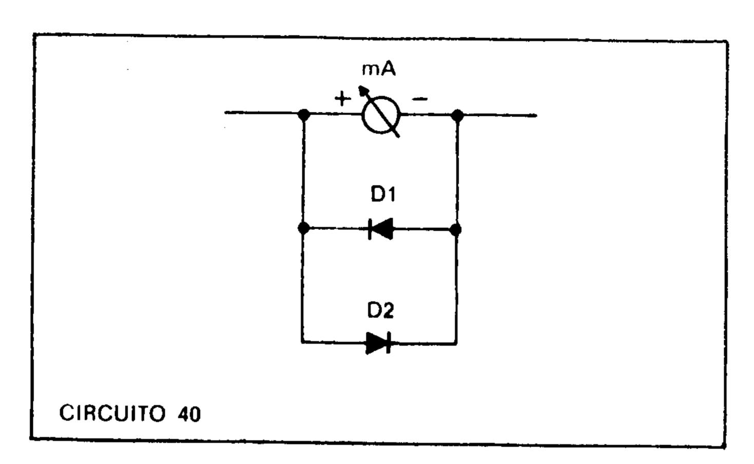
culto, tal limite de sobrecarga do instrumento não será alcançado, e com isso o medidor ficará protegido.
