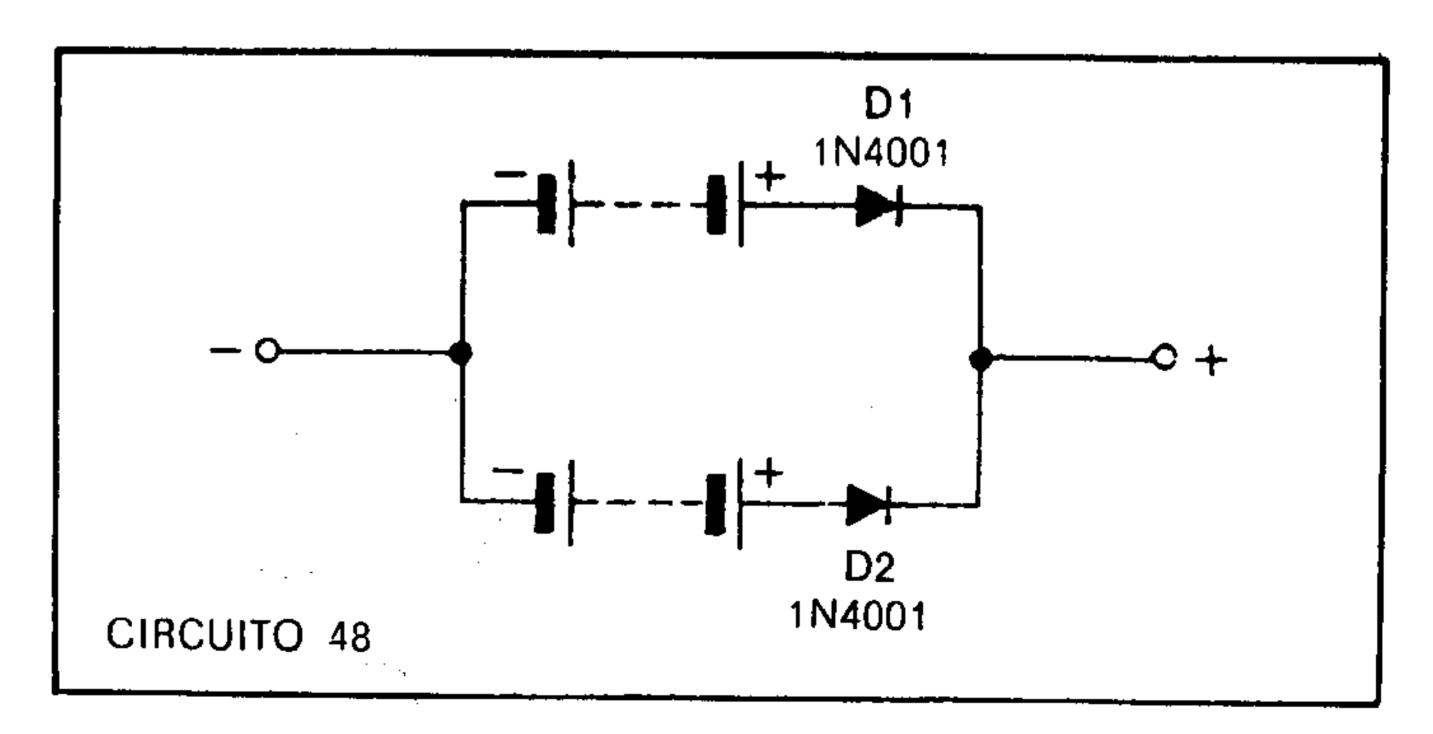
for requisitada, diodos para maiores correntes, como 3 A, 10 A ou 35 A, deverão ser usados.
