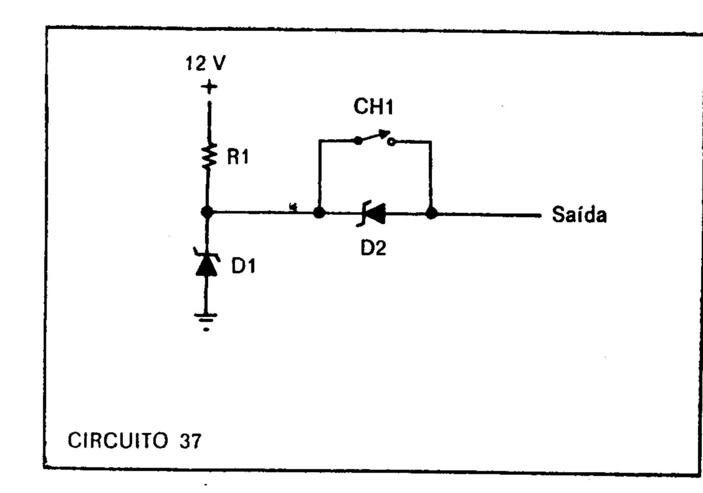
No circuito 37 os dois diodos zener são usados como exemplo. O zener D1 estabiliza a tensão em 9,1 V.
