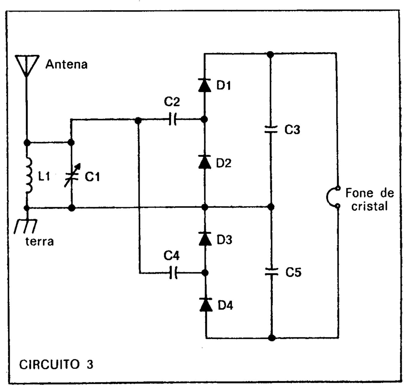
A bobina é a mesma do circuito anterior, sendo também importante que o fone a ser utilizado seja de cristal, além do emprego de uma boa antena e tomada de terra.
