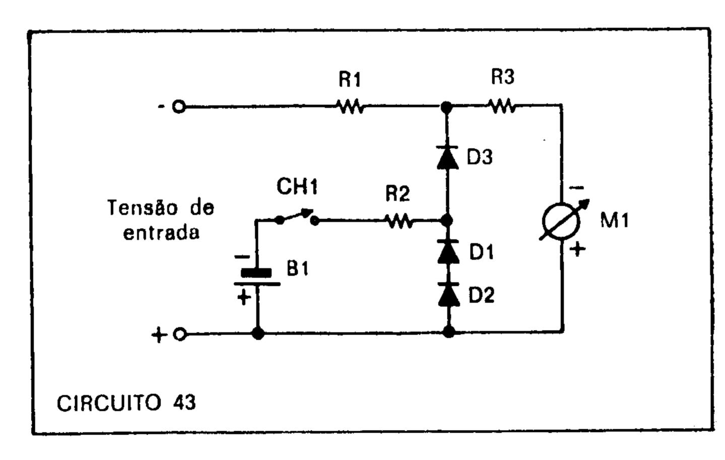
terias até 9 V com a mesma escala. A escala é expandida até cerca de 2 V, sendo gradativamente comprimida até 10 V.
