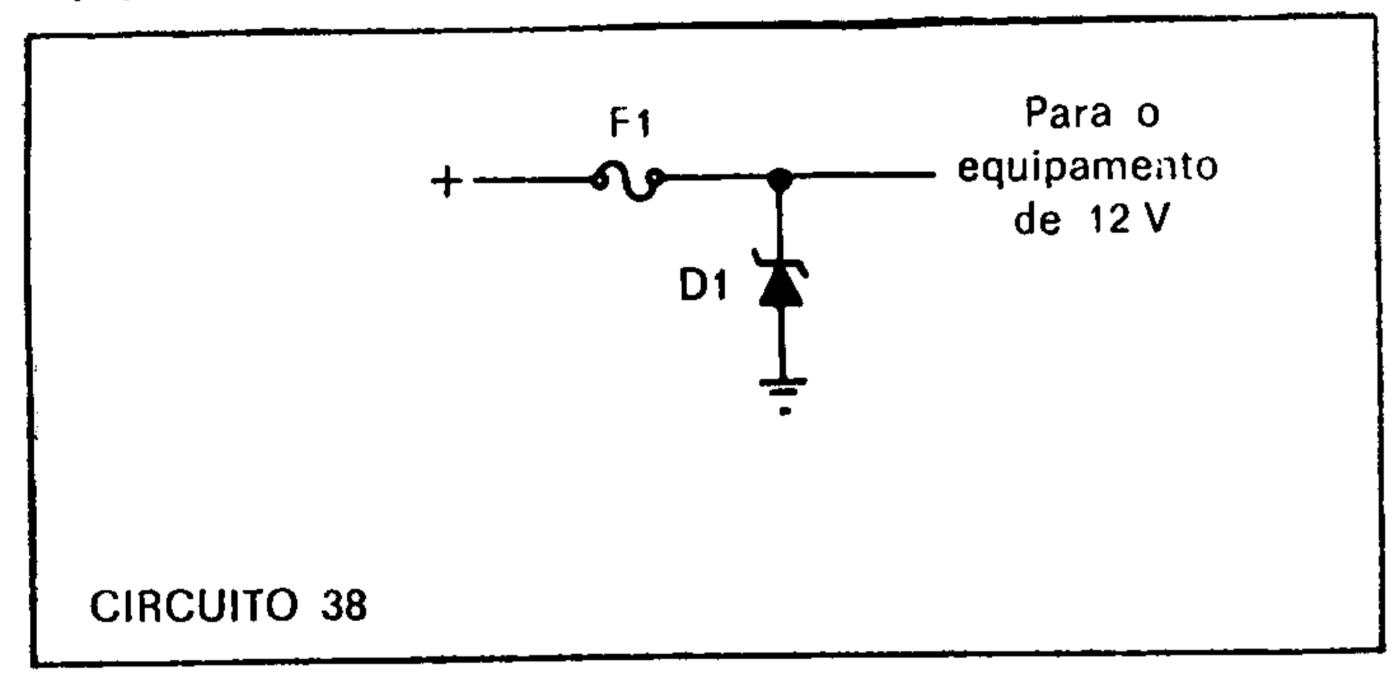
No circuito acima, se a tensão ultrapassar 15 V, o diodo zener irá conduzir, permitindo a passagem de uma grande corrente e, com isso, o fusível queimará, desligando a alimentação.
