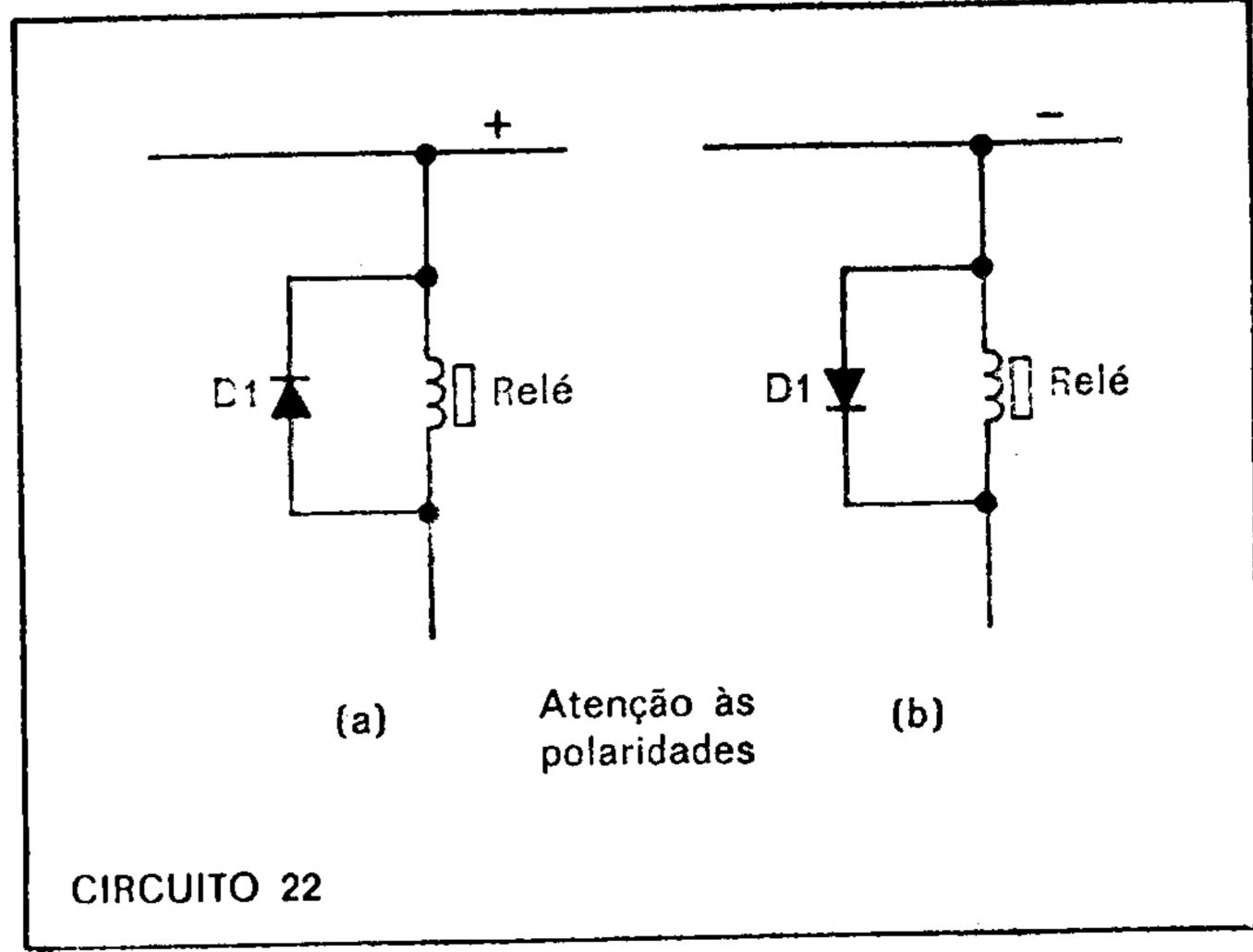
relação a esta força, conduzindo e curto-circuitando a força contra-eletromotriz e, por conseguinte, eliminando a fonte de centelhamento.
