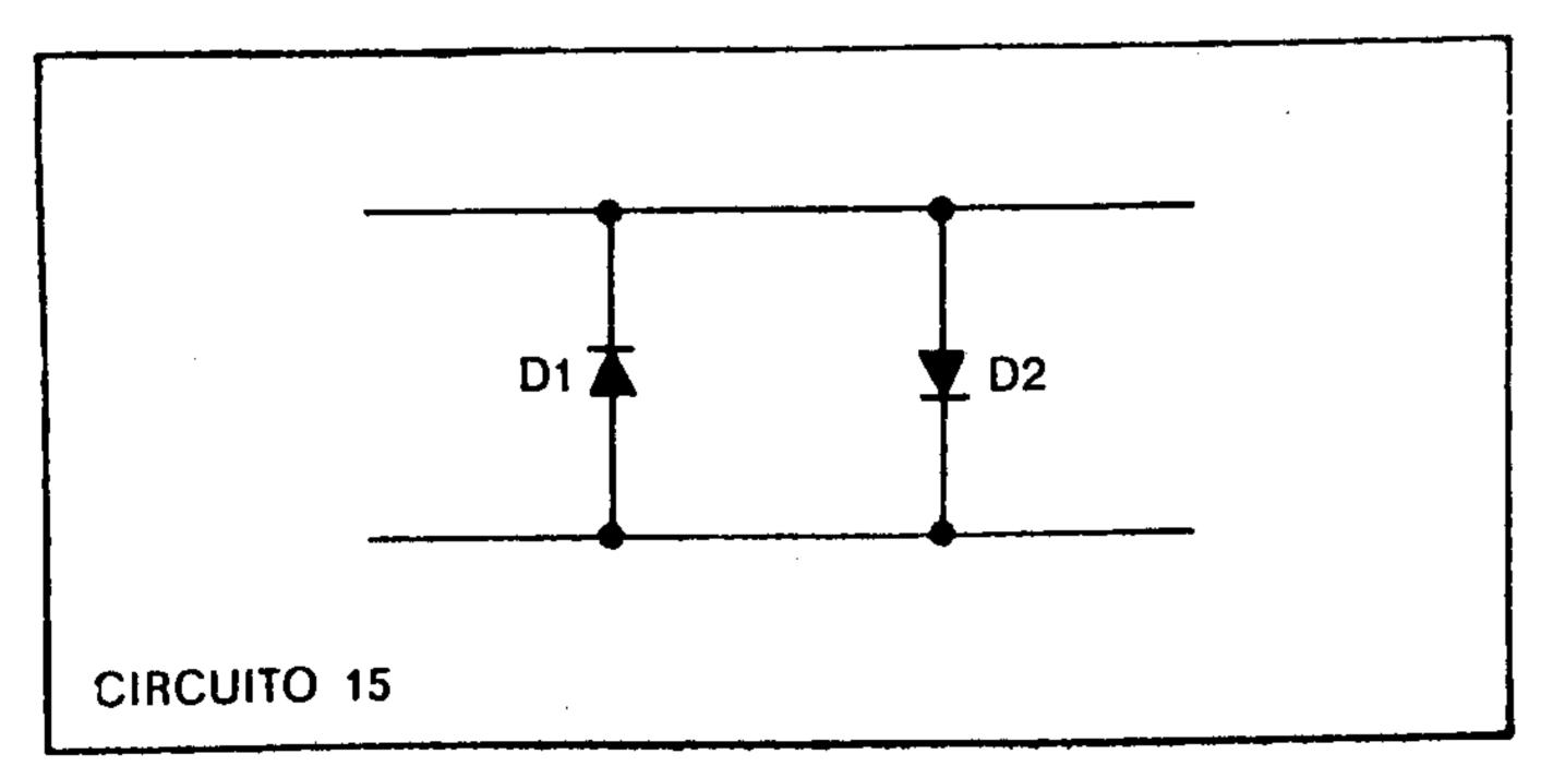
cas de comutação rápida, enquanto que diodos de silício para retificação do tipo BY127 não são adequados neste circuito por serem fabricados para uso em baixa freqüência, como 50 e 60 Hz, que são as freqüências de rede elétrica.
