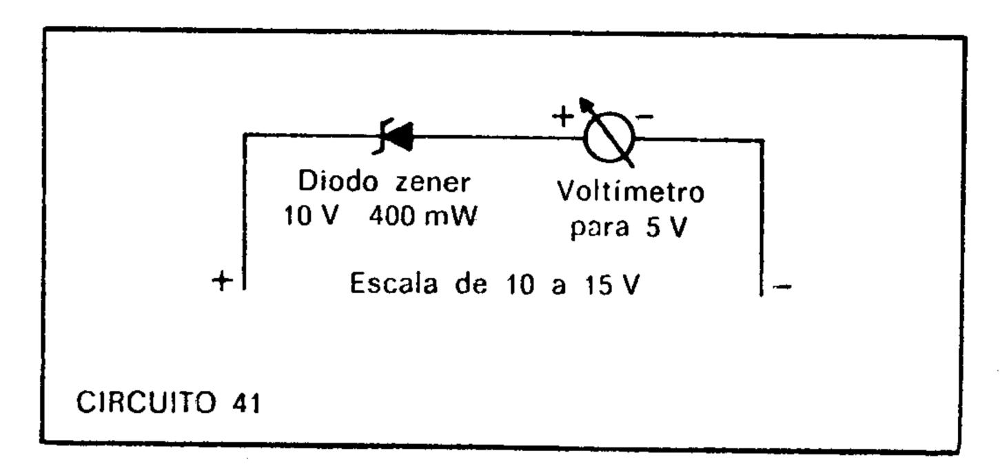
400 mW, é conectado em série com um voltímetro de 5 V. A escala do voltímetro deverá ser recalibrada, de 10 a 15 V, em substituição às marcações anteriores (0 a 5 V).
