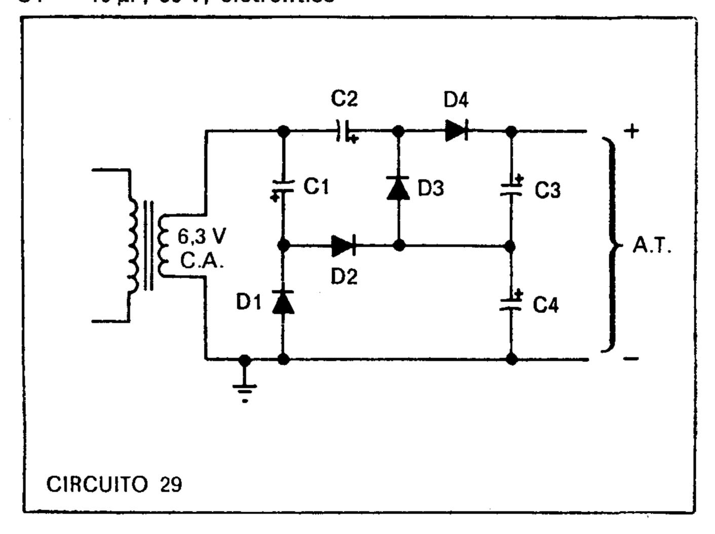
sob baixa corrente, a partir de uma tensão alternada de 6,3 V aplicada à sua entrada. Isto o torna particularmente interessante para o uso em rádios a válvulas alimentados por bateria, pois, devido ao grande declínio do uso de válvulas, os transformadores com enrolamentos de alta tensão estão ficando cada vez mais difíceis de ser obtidos.
