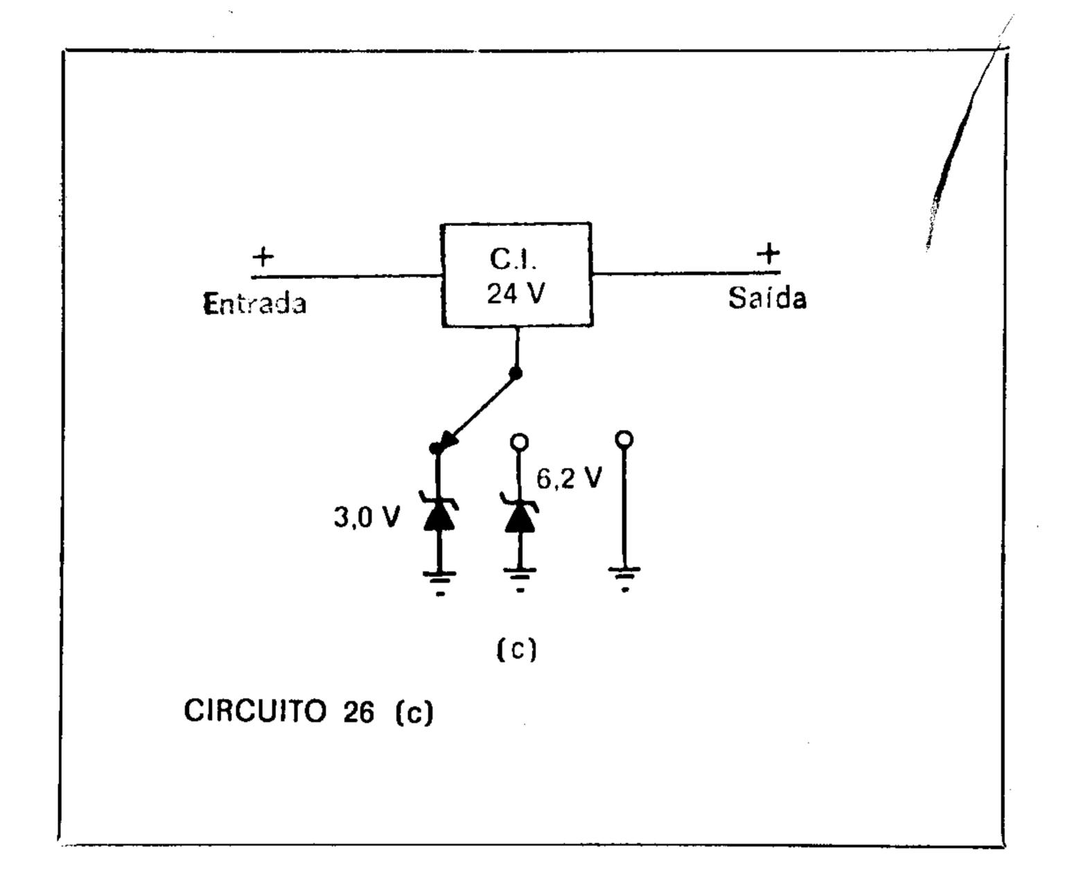
componentes nos proporcionam um meio simples e confiável para a regulação de tensão. Mas o que devemos fazer se quisermos tensões não padronizadas como, por exemplo, 27 V?
