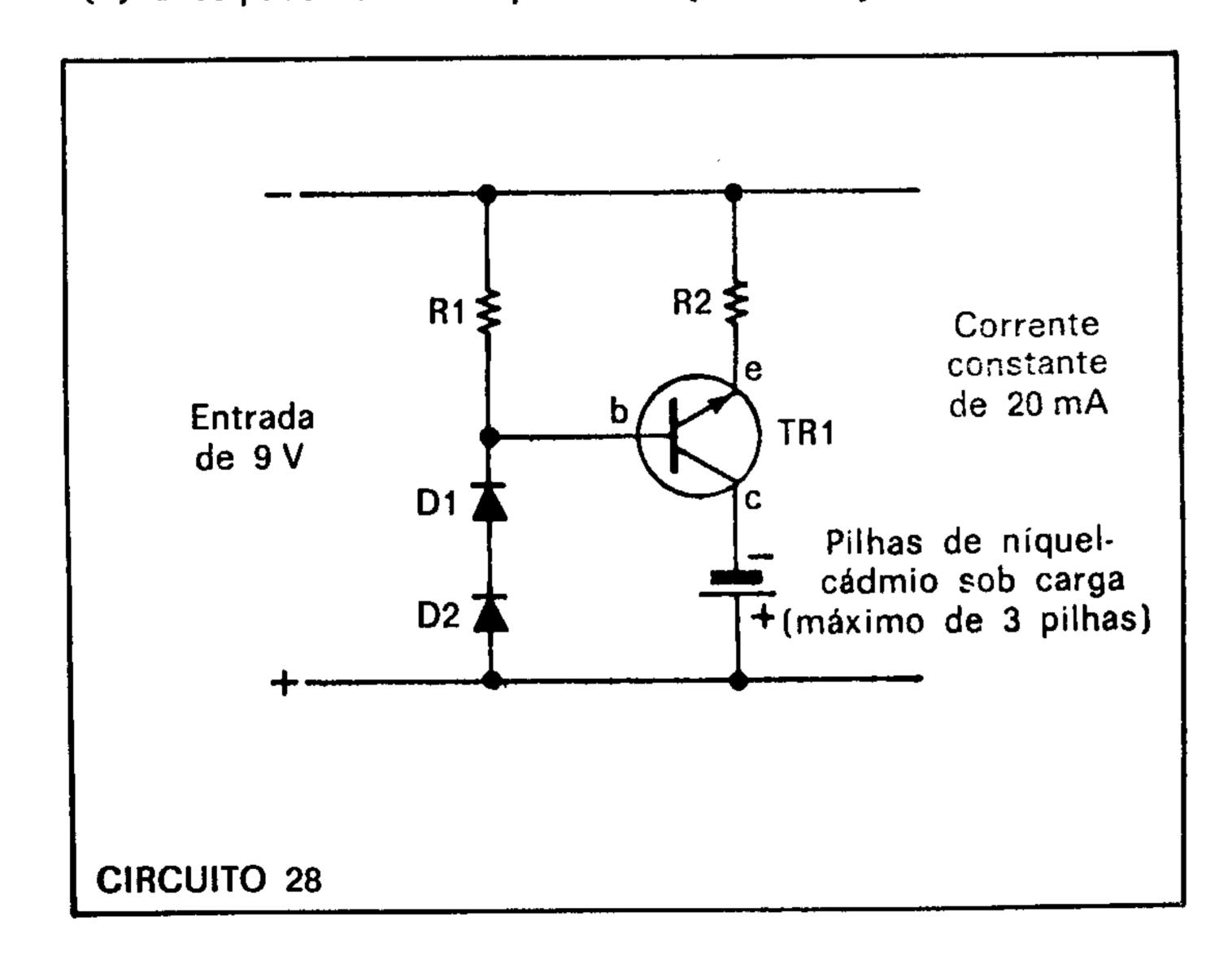
nentes constituem uma fonte de corrente constante capaz de fornecer cerca de 20 mA. O carregador requer uma tensão de 9 V, que pode ser obtida de um eliminador de pilhas comum para rádios transistorizados.
