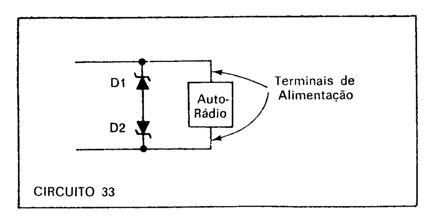
Este circuito limita picos de tensão de qualquer polaridade, podendo, por isso, ser utilizado em carros com chassi positivo ou negativo.
