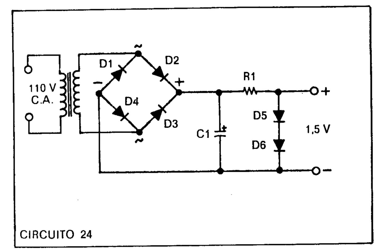
A tensão deve ser bem filtrada, a fim de evitar o aparecimento de zumbido. Utilizamos para isso um capacitor de 5.000 µF. Uma boa idéia é colocar a fonte de alimentação no espaço antes ocupado pelas baterias de alta e de baixa tensão.
