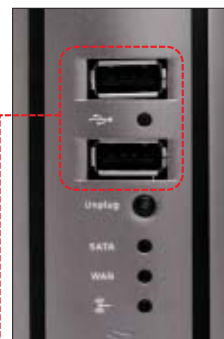
Wiele dysków sieciowych jest wyposażanych w porty USB, do których możemy podłączyć na przykład pendrive. Będzie on automatycznie udostępniony w sieci
