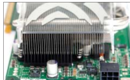
MSI ma zamontowany seryjny radiator od GeForce 7900
