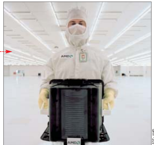
Materiały światłoczułe używane w procesie litografii nie reagują na żółte światło, którym oświetlone są cleanroomy
