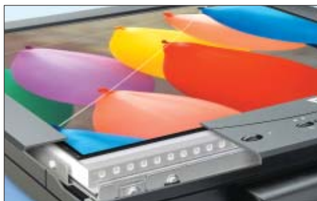
Klasyczne podświetlenie CCFL zastąpiono trójkolorowymi diodami LED, produkowanymi przez firmę OSRAM
