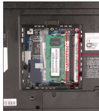
Wbrew pozorom dodawanie pamięci RAM do notebooka nie wymaga wizyty w serwisie. Wystarczy odkręcić dwie śrubki i zdjąć klapkę, pod którą znajdziemy wolne złącze ● na kość RAM
