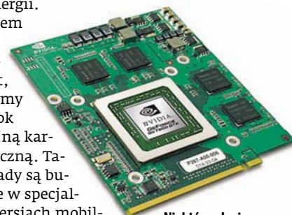
Niektóre, droższe modele notebooków wyposażone są w karty graficzne, które możemy wymienić (więcej informacji w numerze 12/2005)
