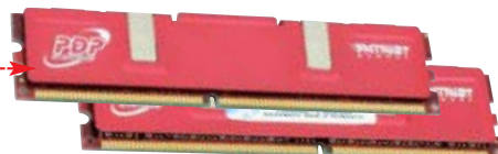
Nowoczesne moduły DDR/DDR2 są wyposażone w niewielkie radiatory, które pomagają odprowadzać ciepło z układów pamięci
