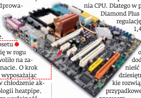
ABIT AN8 32X został zaopatrzone w pasywne chłodzenie oparte na technologii heatpipe. Dzięki temu jest całkowicie bezgłośny
