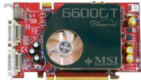
Układ Core Cell 3D zamontowany na karcie MSI NX6600GT-VT2D128E Diamond umożliwia nie tylko zmianę taktowania, ale także regulację napięcia
