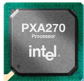
Procesory Intel to najsilniejsze i najpopularniejsze CPU dla palmtopów z Windows. Najnowszy układ PXA27x obsługuje nawet instrukcje MMX
