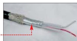
Kabel ekranowany z widocznym ekranem
