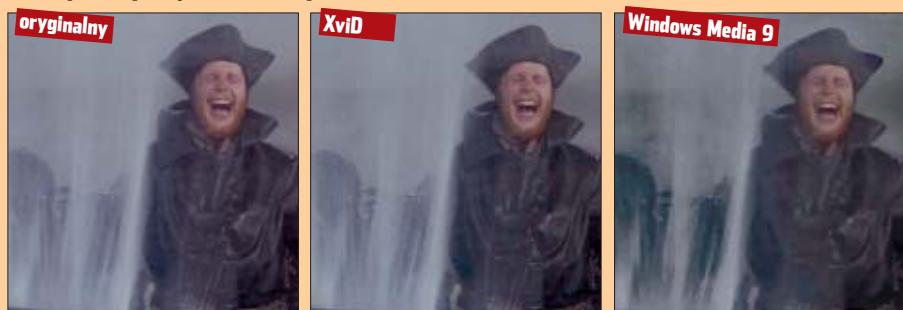
Filmy pełne dynamicznych scen najlepiej kompresować XviD-em. Natomiast kodek Microsoftu powoduje najwięcej zakłóceń
