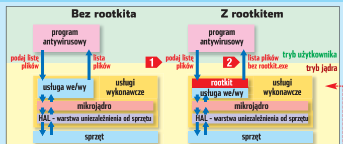
Schemat pokazuje różnicę w działaniu zdrowego systemu oraz zainfekowanego przez rootkit. Program hakerski ukrywa swoje istnienie przed zewnętrznymi aplikacjami.
