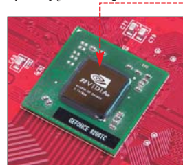
Rdzeń karty wykonany w procesie 110 nm jest fizycznie dużo mniejszy, niż rdzenie stosowane w silniejszych odmianach GeForce 6
