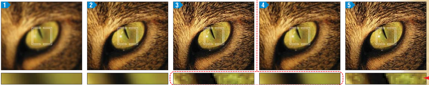
Pomiar ostrości metodą detekcji kontrastu jest dość powolny, gdyż automatyka musi przeanalizować obraz niemal przy każdym ustawieniu soczewek, zanim określi, kiedy jest najostrzejszy. Proces znajdowania optymalnego ustawienia wygląda następująco: 1 pierwszy pomiar, 2 i 3 automatyka przesuwa soczewkę i sprawdza kontrast, 4 jeśli w kolejnym kroku kontrast był mniejszy niż w poprzednim, autofocus wraca do najlepszego ustawienia 5
