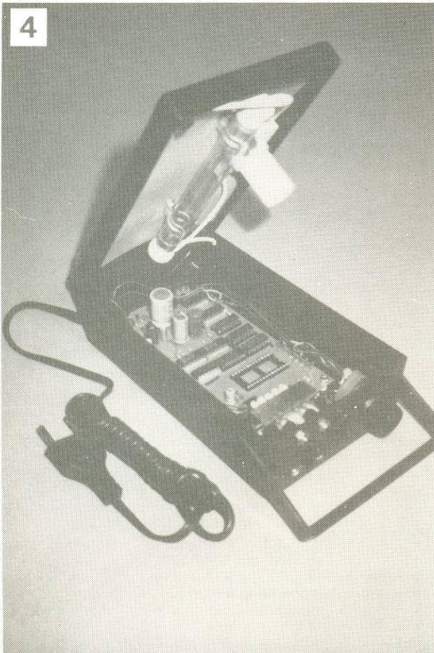
figura 4 — Aspecto do protótipo feito com a versão nacional do circuito. Repare bem no tipo da lâmpada utilizada, pois é diferente do sugerido na versão original.
