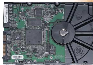
Dyski pozbawione są dolnej blaszki ochronnej. Podczas montażu uważajmy, aby ich nie uszkodzić
