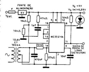
fonte e portanto, também o fusível. O MC3324 consiste num duplo comparador de tensão projetado especialmente para supervisão de fontes de alimentação. Este integrado pode operar com tensões de 4,5 a 40 V e sua saída pode fornecer uma corrente de 300 mA (pino 8 e pino 10) para o disparo de SCRs.
