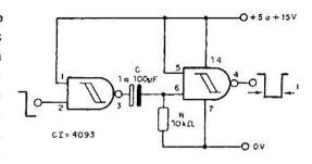
para C= 1 500  $\mu F$  e R= 1,5 M $\Omega$ . A alimentação é feita com fonte simples de 5 a 15 V.
