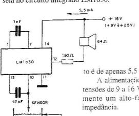
O sensor é de contato com o líquido, no caso uma ponta de fio descascado. Com uma alimentação de 16 V, o consumo do circui-
