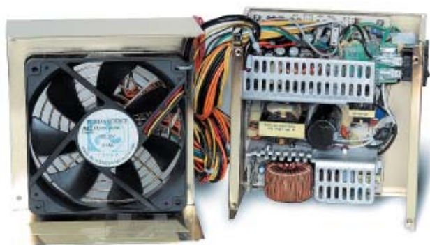
Potężny wentylator w modelu HuntKey HK-400-XP zapewnia duży przepływ powietrza przy niskiej prędkości obrotowej. Oznacza to nieco cichszą pracę
