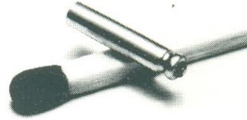
figura 2 - A menor pilha de lítio do mundo é produzida pela Panasonic. A BR211 tem apenas 2,2 mm de diâmetro, 11 mm de comprimento, 5,4 mAh de capacidade, 3 V de f.e.m. e 0,9 g de peso.
