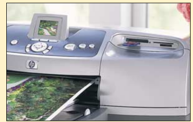
Fotograficzna drukarka firmy HP ma kolorowy wyświetlacz LCD i wbudowany czytnik kart pamięci
