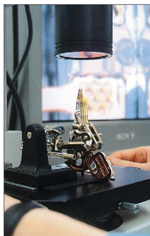
Głowicę dysku umieszcza się pod mikroskopem w specjalnym uchwycie
