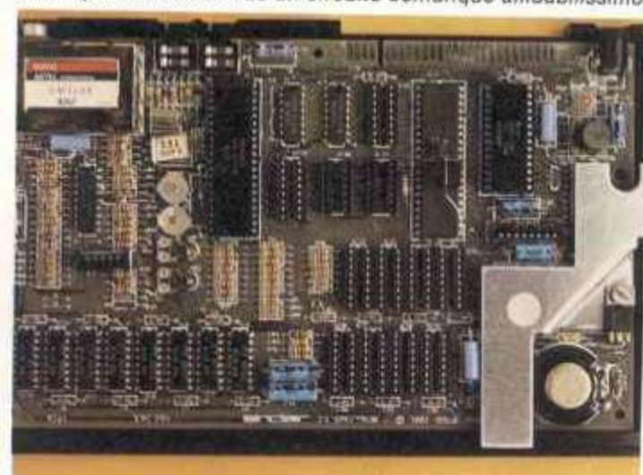
Il compatto interno contiene la CPU Z80, il circuito ULA di progettazione Sinclair che svolge quasi tutte le funzioni di sistema, la ROM contenente il software del monitor e dell'interprete, la memoria RAM. In alto a sinistra il modulatore, schermato, per la generazione dei segnali video.
