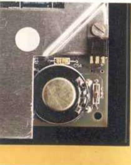
Il beeper ottenuto con un altoparlante ben collocato in uno spigolo della piastra madre.
