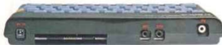
La foto evidenzia l'estrema sottigliezza dello Spectrum, e l'esemplare semplicità e completezza del set di prese di collegamento in/out.
