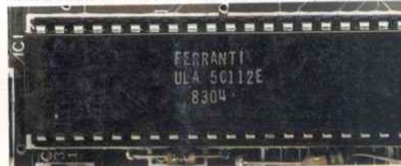
La ULA, il circuito custom che permette allo Spectrum potentissime funzioni in spazi decisamente ristretti.
