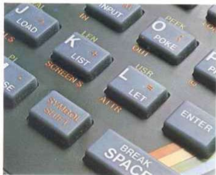
Particolare della tastiera "gommosa": ad ogni testo sono associate fino a 5 funzioni: dopo alcune ore di necessario impraticamento la disposizione delle varie funzioni si rivela un capolavoro di razionalità.
