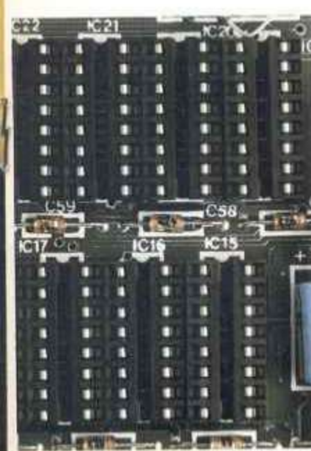
Gli ottimi zoccoli di alloggiamento dell'espansione di memoria, che porta il sistema alla ragguardevole capacità di 48 Kbyte di RAM.
