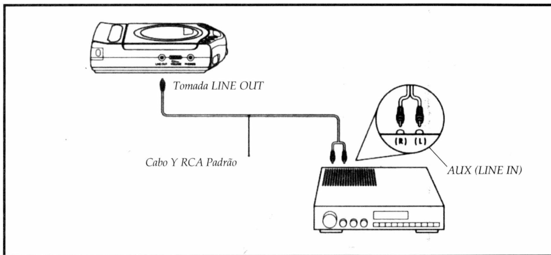
1. Conecte a extremidade do plugue único de um cabo Y RCA de áudio padrão (não incluído - pode ser comprado em lojas eletrônicas) à tomada LINE OUT de áudio existente no lado esquerdo do console do MULTI-MEGA CDX.
