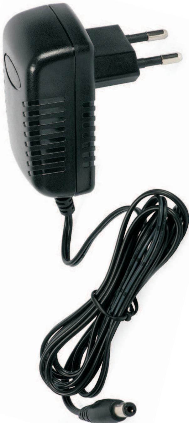
A fonte a ser utilizada deve ser regulada de 12 Volts com pelo menos 1 Ampere de corrente. O encaixe deve ser padrão "P4" tendo o positivo no pino central.
