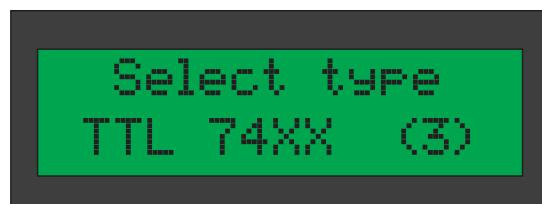
**Não coloque qualquer componente no soquete z.i.f. antes de ligar o equipamento!**
