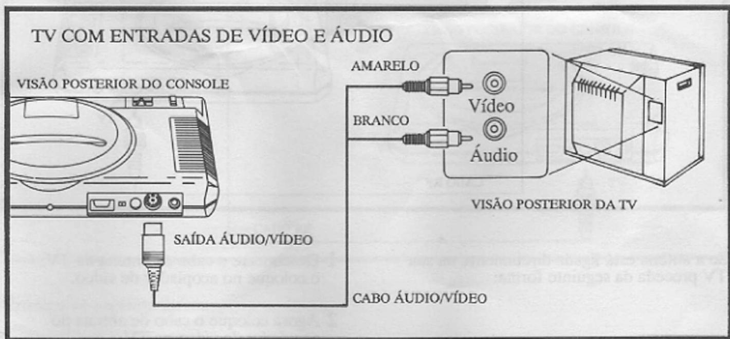
Se sua TV tem entradas de áudio e vídeo (geralmente na parte posterior de modelos mais recentes de TV), a conexão pode ser feita utilizando o cabo Áudio Vídeo. Este cabo possui uma ponta com plugue DIN e outras duas pontas com plugue RCA (ver ilustração).
